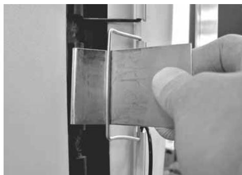
Prender o gancho metálico com a ferramenta de elevação
