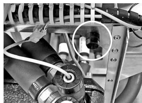
Sensor mSTB com desbloqueador
